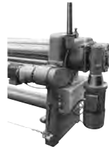
Napęd walca gnącego, wyłącznik awaryjny i silnik z hamulcem
